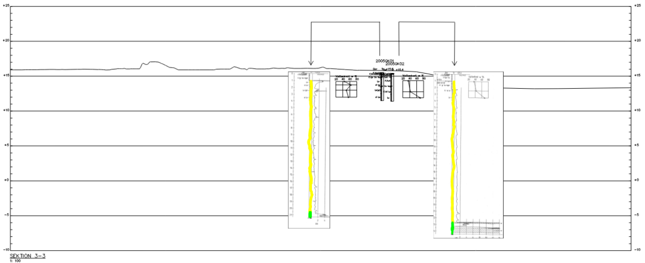
Figur 21 Arkiv undersökningar uppritade i sektion 3. Gul färg symboliserar lera, grön symboliserar friktionsjord.
